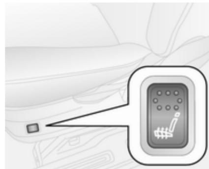
Attivare il riscaldamento premendo il pulsante
