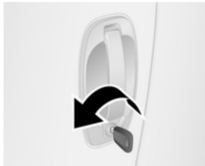
Ruotare la chiave nella serratura della portiera del conducente verso la parte anteriore del veicolo.
