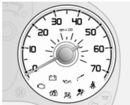
Indica la velocità di rotazione del motore.
