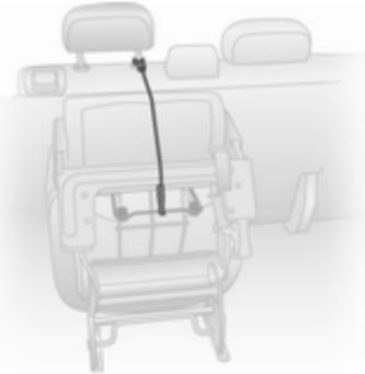
3. Accertarsi che il sedile ripiegato sia in posizione verticale fissando il cavo flessibile (situato sul telaio del sedile) al poggiatesta del sedile di fronte al sedile ripiegato.
