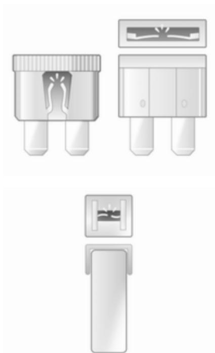
A seconda del tipo di fusibile, un fusibile bruciato si riconosce dalla fusione del filo metallico all'interno. Sostituire il fusibile solo dopo aver eliminato la causa del guasto.
