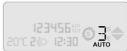
Il display del cambio visualizza la modalità e la marcia corrente del cambio manuale automatizzato.
