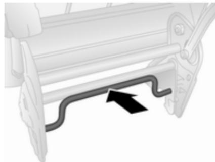
2. Spingere la leva inferiore per sganciare i fermi e rimuovere il gruppo sedile dai punti di ancoraggio a pavimento.
