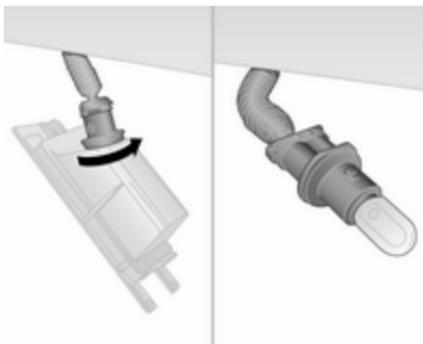
2. Ruotare il portalampada in senso antiorario per smontarlo dall'alloggiamento della lampadina. Estrarre la lampadina e rimuoverla.
