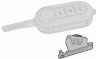
Estrarre la chiave (per accedere al portabatteria) e smontare il portabatteria svitando la vite con un cacciavite adatto. Smontare il portabatteria dalla
