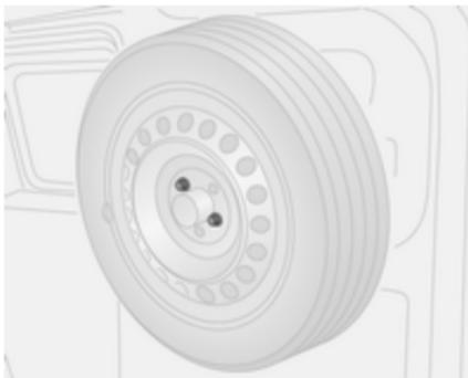
1. Svitare due viti utilizzando la chiave e rimuovere la ruota di scorta dalla staffa. Attrezzi per il veicolo ⇨ 164.
