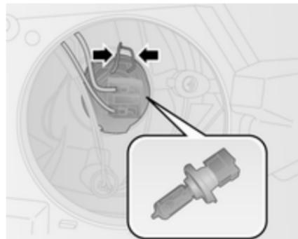
4. Inserire una nuova lampadina nel riflettore in modo che la linguetta di riferimento della lampadina sia allineata con la cavità del riflettore.
