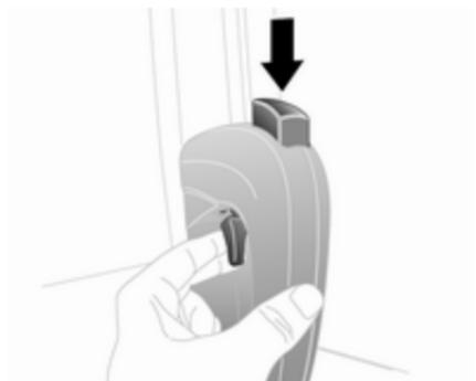
Spingere all'interno la manopola di blocco sulla parte superiore della maniglia interna (se presente) della/e portiera/e laterale/i scorrevole/i e/o inserire il blocco manuale sulla portiera laterale scorrevole (se presente), come indicato di seguito. Quindi chiudere la portiera dall'esterno.
