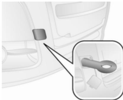
Sbloccare la copertura sollevandola delicatamente con un cacciavite. Utilizzare un panno tra il cacciavite e il telaio per evitare eventuali danni.
