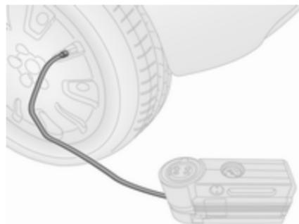
5. Avvitare il flessibile sulla valvola del pneumatico.
