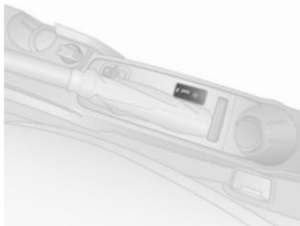
Una porta USB e una presa AUX per il collegamento di fonti audio esterne sono collocate nella parte posteriore della consolle centrale.
