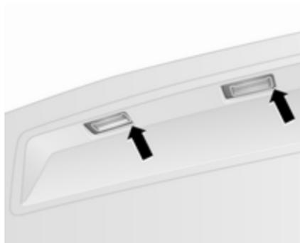
1. Inserire il cacciavite come indicato dalle frecce, premere a sinistra e sbloccare l'alloggiamento della lampadina.
