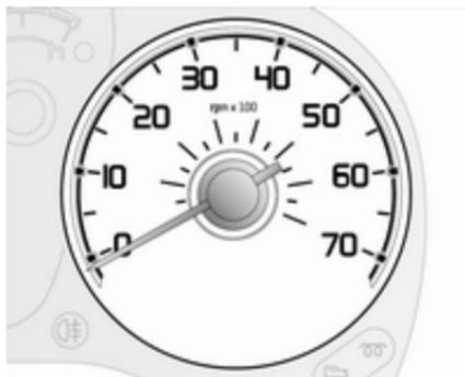
Indica la velocità di rotazione del motore.
