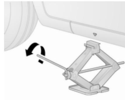
Con il martinetto correttamente allineato, ruotare fino a quando la ruota non poggia più per terra.
