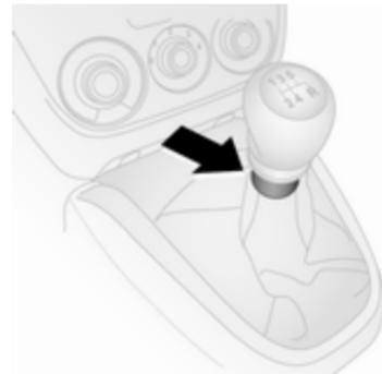
Per inserire la retromarcia, con il veicolo fermo, attendere tre secondi premendo il pedale della frizione, sollevare il collare sulla leva del cambio e innestare la marcia.
