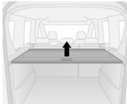
Il ripiano portapacchi posteriore può essere montato in due posizioni, cioè posizione superiore
