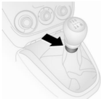
Retromarcia: con il veicolo fermo, attendere tre secondi premendo il pedale della frizione, sollevare il collare sulla leva del cambio e innestare la marcia.
