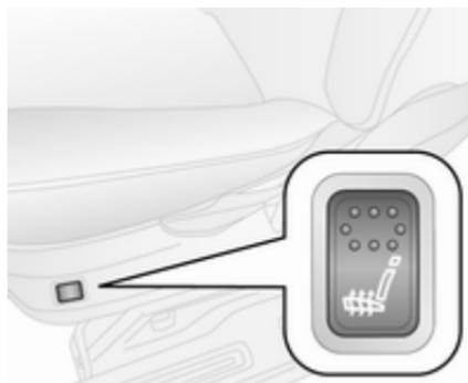
Attivare il riscaldamento del sedile premendo
