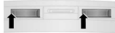
1. Inserire il cacciavite come indicato dalle frecce, premere di lato e sbloccare l'alloggiamento della lampadina.
