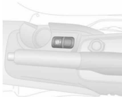
Disattivare il sistema stop-start manualmente premendo
