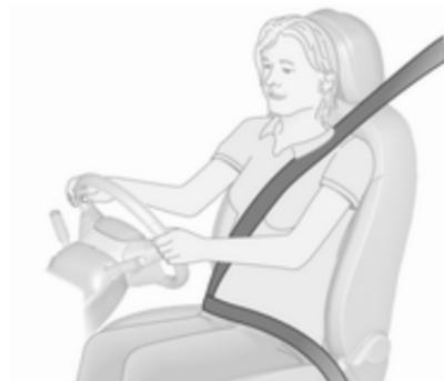
Le cinture di sicurezza sono bloccate durante le accelerazioni e decelerazioni brusche del veicolo, per mantenere gli occupanti dell'auto in posizione corretta. Pertanto il rischio di lesioni si riduce notevolmente.
