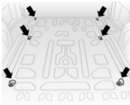
Gli occhielli di ancoraggio servono per fissare gli oggetti ed evitare che scivolino, ad es. utilizzando delle cinghie di ancoraggio o una rete fermabagagli.
