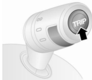
In base alla versione, le seguenti funzioni possono essere selezionate premendo ripetutamente **TRIP** sull'estremità della leva del tergicristalli:
