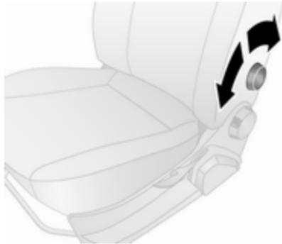
Ruotare la manopola per regolare il supporto lombare secondo necessità. La manopola consente di aumentare o diminuire il supporto lombare.
