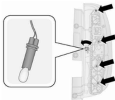
4. Svitare le quattro viti di fermo utilizzando un cacciavite. Ruotare il portalampada della luce della retromarcia in senso antiorario e sostituire la lampadina.
