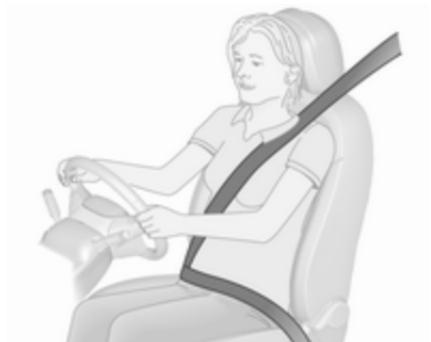
Regolare l'altezza della cintura in modo che questa poggi sulla spalla, e non sul collo o sul braccio.
