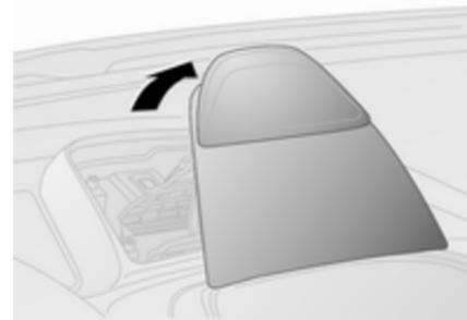
Tirare la parte posteriore del portadocumenti verso l'alto dal quadro strumenti e lasciarlo in posizione inclinata.
