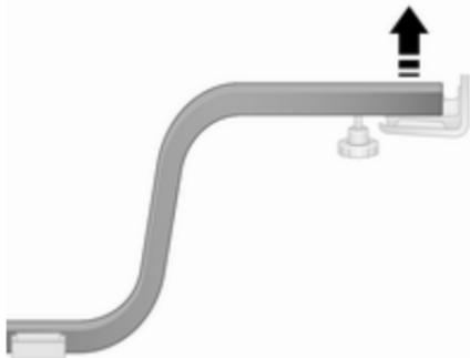
3. Spingere la barra del tetto verso l'alto per sbloccare dalla staffa su entrambi i lati e rimuovere completamente la barra del tetto.
