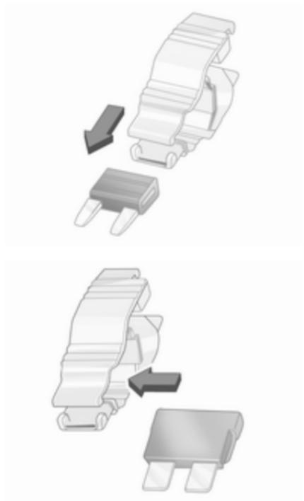
Per facilitare l'operazione si può utilizzare un attrezzo per estrarre i fusibili. Posizionare l'estrattore per fusibili sulla sommità o sul lato del fusibile, a seconda del tipo, ed estrarre il fusibile.
