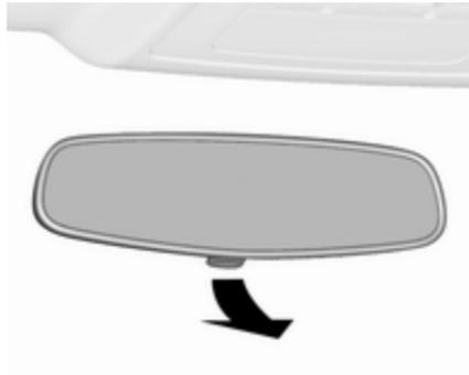
Per ridurre l'abbagliamento, agire sulla leva nella parte inferiore del corpo dello specchietto.
