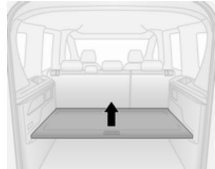
o posizione inferiore. Nella posizione superiore, il carico massimo ammesso è 70 kg.
