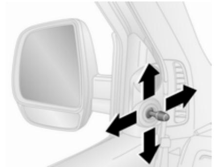
Regolare gli specchietti ruotando la leva nella direzione necessaria.
