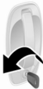
Sbloccare manualmente la portiera del conducente inserendo la chiave nel cilindretto della serratura e ruotandola verso la parte anteriore del veicolo. Aprire la portiera del conducente tirando la maniglia esterna.
