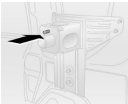
3. Posizionare la ruota sostituita sulla staffa assicurando il corretto allineamento del perno di riferimento.
