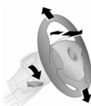
Sbloccare la leva, regolare la posizione del volante, quindi riportare la leva in posizione iniziale e accertarsi che sia completamente bloccata.
