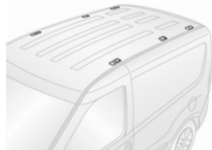
Per fissare un portapacchi, inserire i bulloni di montaggio nei fori indicati nell'illustrazione.
