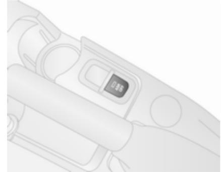
È possibile disattivare il dispositivo ASR quando è richiesto lo slittamento delle ruote motrici: premere brevemente **ASR OFF**.
