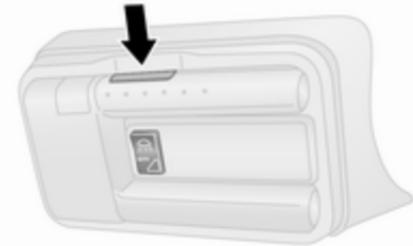
In base alla variante di modello, la luce di cortesia posteriore rimovibile potrebbe illuminarsi quando le portiere posteriori / portellone posteriore o le portiere laterali scorrevoli vengono aperte e l'interruttore centrale si trova in posizione centrale.
