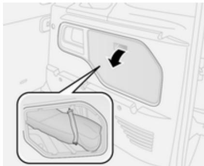
Gli attrezzi e l'equipaggiamento per il sollevamento del veicolo sono riposti nel vano di carico dietro un pannello sul lato destro.
