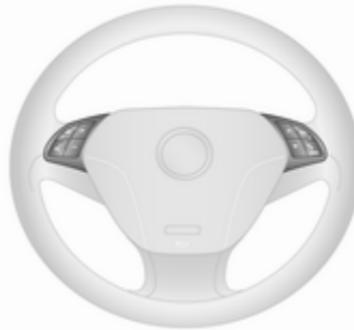
È possibile utilizzare il sistema Infotainment e un telefono cellulare collegato tramite i comandi al volante.
