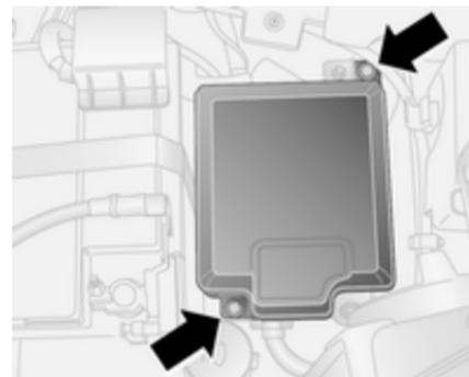
La scatola portafusibili si trova a destra del vano motore, accanto alla batteria del veicolo.
